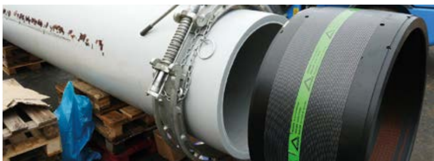
Ausgleich von Rohrovalitäten mithilfe einer Rundungsschelle FWXRH
